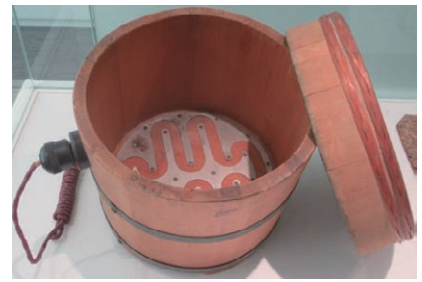
図 13 東京通信研究所試作の電極式炊飯器
