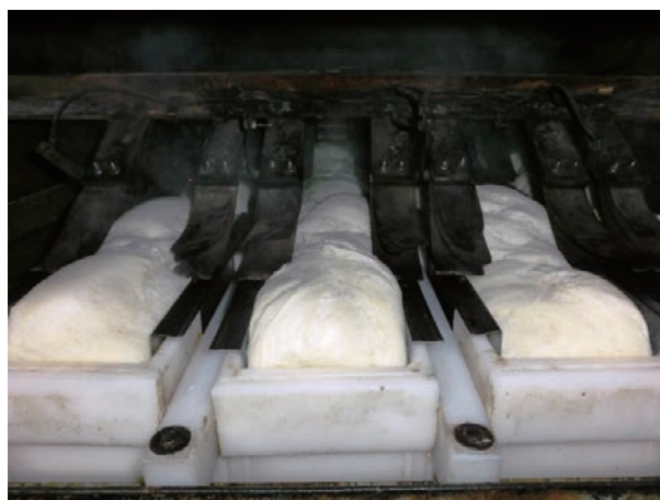
図4 パン粉製造工場の業務用の電極式パン焼き器 39)
